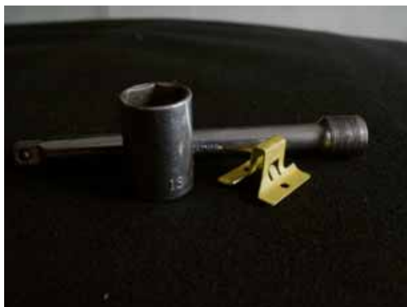
13er Nuss als Aufnahme- und Versetzwerkzeug für die gelben Panel-Klammern
